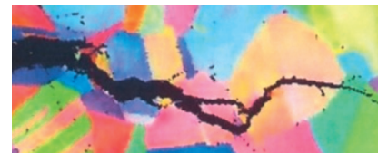
Spannungsrissskorrosion in einem Edelstahl
