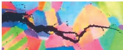
Spannungsrissskorrosion in einem Edelstahl
