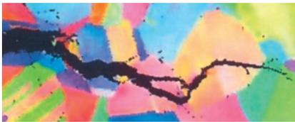
Spannungsrissskorrosion in einem Edelstahl
